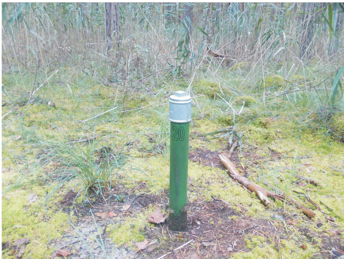
Fot. 14. Piezometr P 20, wykonany na obszarze boru bagiennego w zlewni Czarnej, Staszowskiej (R. Spiżewski).
