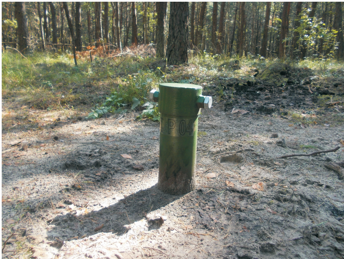
Fot. 07. Piezometr P 04 z automatycznym rejestratorem pierwszego poziomu wód podziemnych na pograniczu torfowiska przejściowego i boru bagiennego, (R. Spiżewski).
