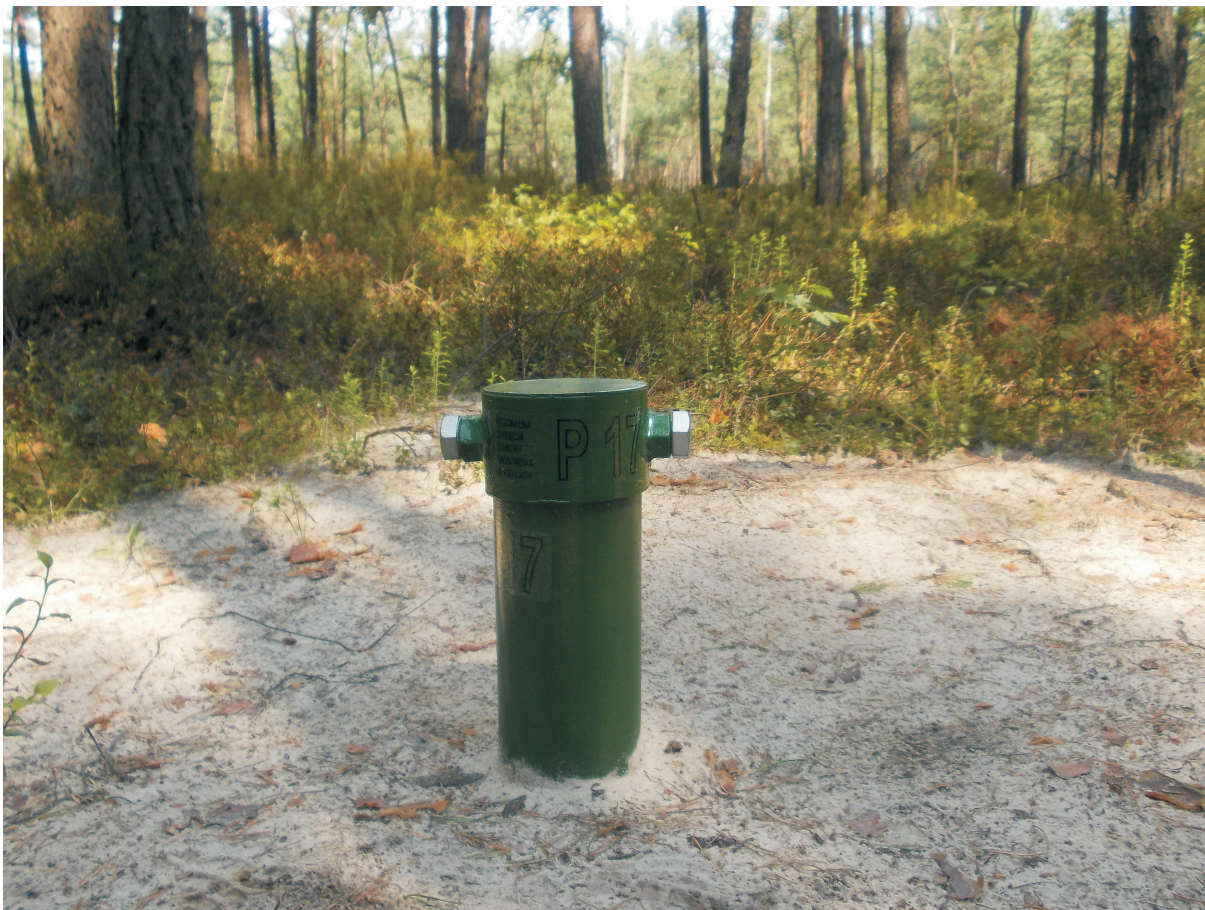
Fot. 13. Piezometr P 17 wykonany w obrębie zespołu boru świeżego w zlewni Czarnej Staszowskiej, rejestrujący automatycznie wahania poziomu wody w układzie godzinowym (R. Spiżewski).
